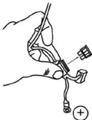
Avant de commencer les travaux, retirez le fusible 25A dans la ligne d'alimentation (U) !
