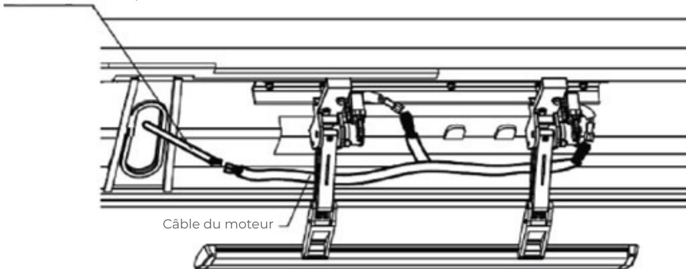
Le câble moteur de l'intérieur est relié aux câbles moteur de l'extérieur. Veillez à ce que les codes couleur soient identiques. Ensuite, les câbles à l'extérieur peuvent être posés à l'abri des intempéries et dans les règles de l'art, puis fixés au véhicule à l'aide de colliers de serrage.
