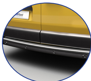
Protection de seuil
